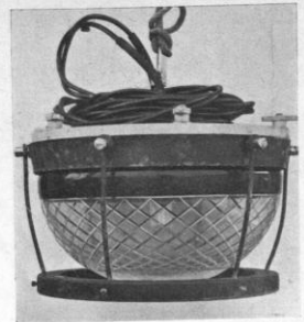
Fig. 3 - Dispositivo adibito in origine, per la pesca con luce subacquea. Nella base a l'accumulatore (3) e l'argano (4) con i fili conduttori della corrente (5) e con (X) massa su fondo marino.
